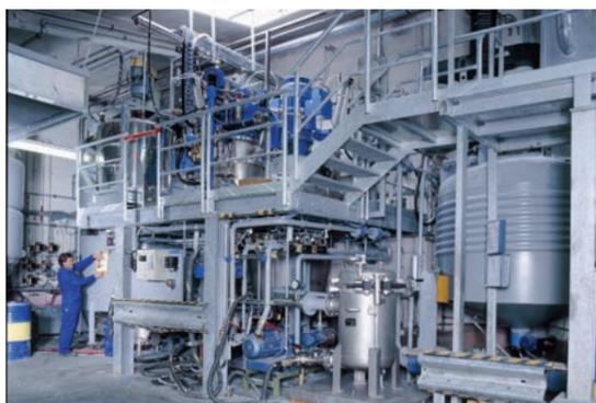
Vakuum-Dissolver als Basiseinheit zur Basecoat-Fertigung
