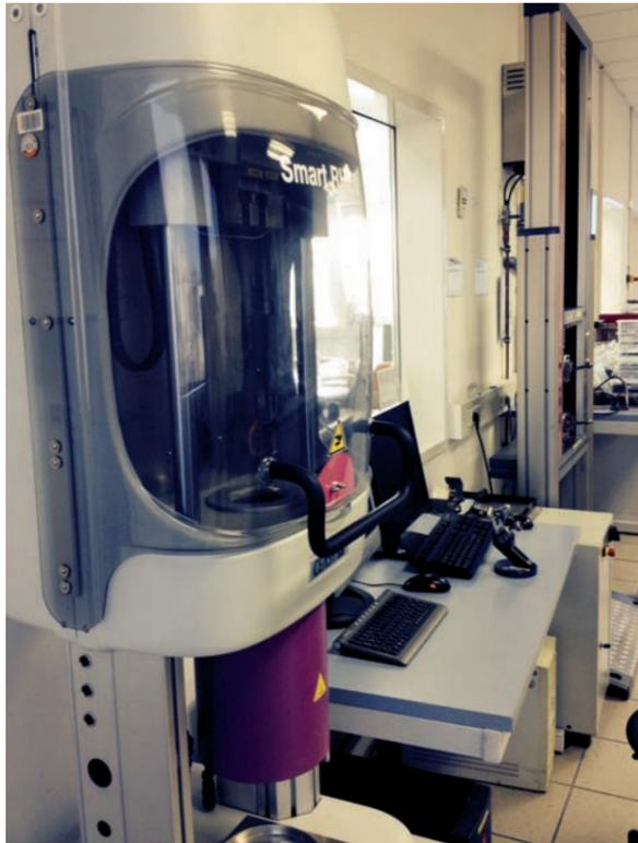
Abbildung 1: Kapillarrheometer SmartRheo von CEAST
