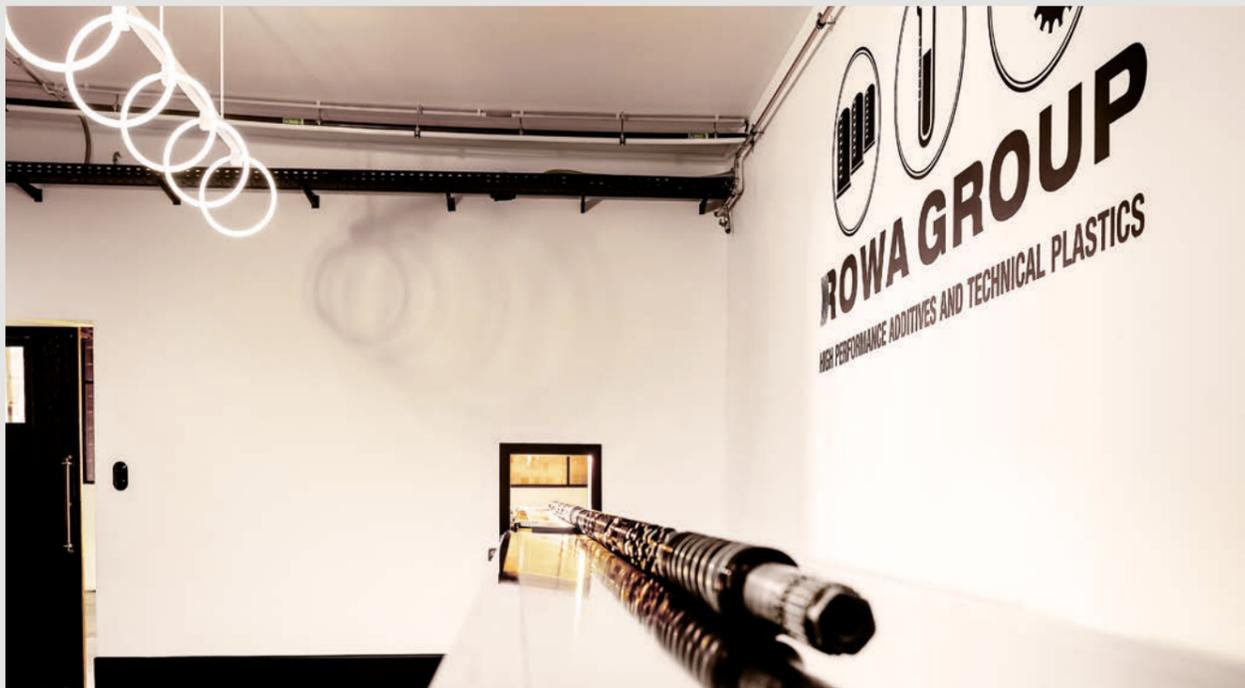
Die Räumlichkeiten des Schneckenhauses sind so konstruiert, dass die Experten von ROWA Masterbatch und ROMIRA im Handumdrehen die gewünschten Schneckenwellen und Schneckenelemente zur Hand haben, um defekte Teile schnell austauschen oder notwendige Änderungen der Schneckenkonfigurationen vornehmen zu können.
