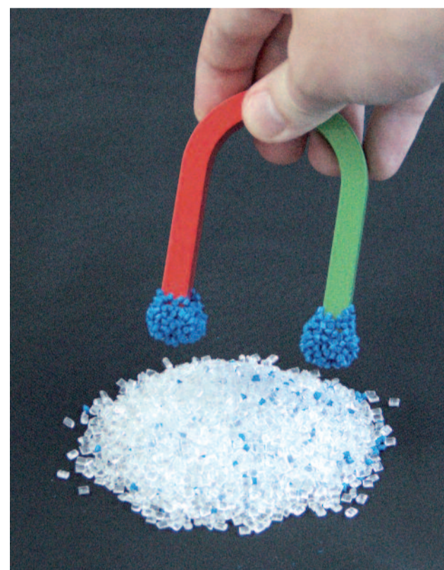
Magnetisch, praktisch, gut: detektierbare Kunststoffe.
